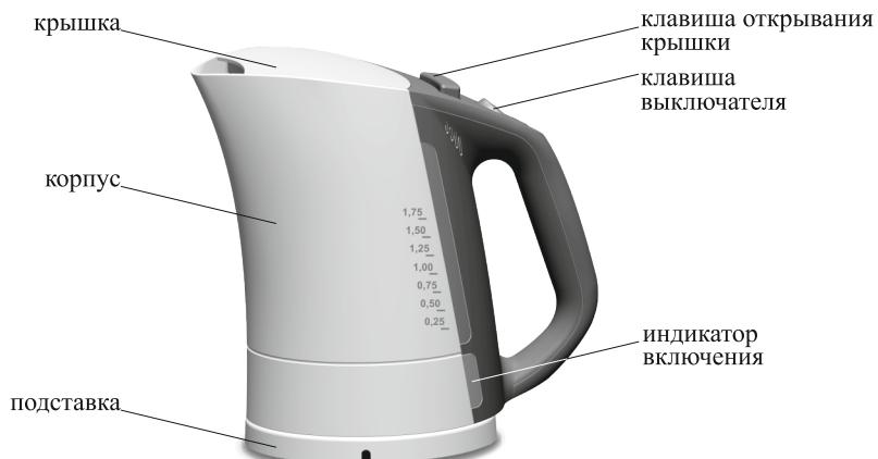
Крышка чайника фиксируется в закрытом положении. Для открытия крышки необходимо нажать на клавишу открывания крышки и довести крышку до вертикального положения.
