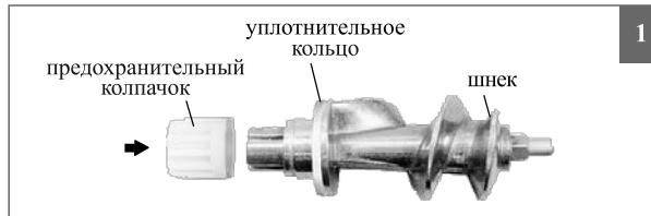
Предохранительный колпачок защищает механизм электромясорубки от поломки. При случайном попадании в процессе переработки в приставку-мясорубку костей и других твердых предметов, а также при перегрузках привода электромясорубки, вызванных нарушением правил эксплуатации изделия, предохранительный колпачок разрушается, шнек перестает вращаться, а привод продолжает работать в режиме холостого хода.
